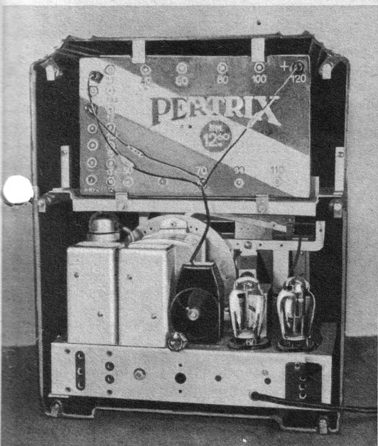
Leicht zugänglich befindet sich die Anodenbatterie über dem Empfänger. Hinter der Anodenbatterie sitzt der Lautsprecher. (Werkphoto Körting)
